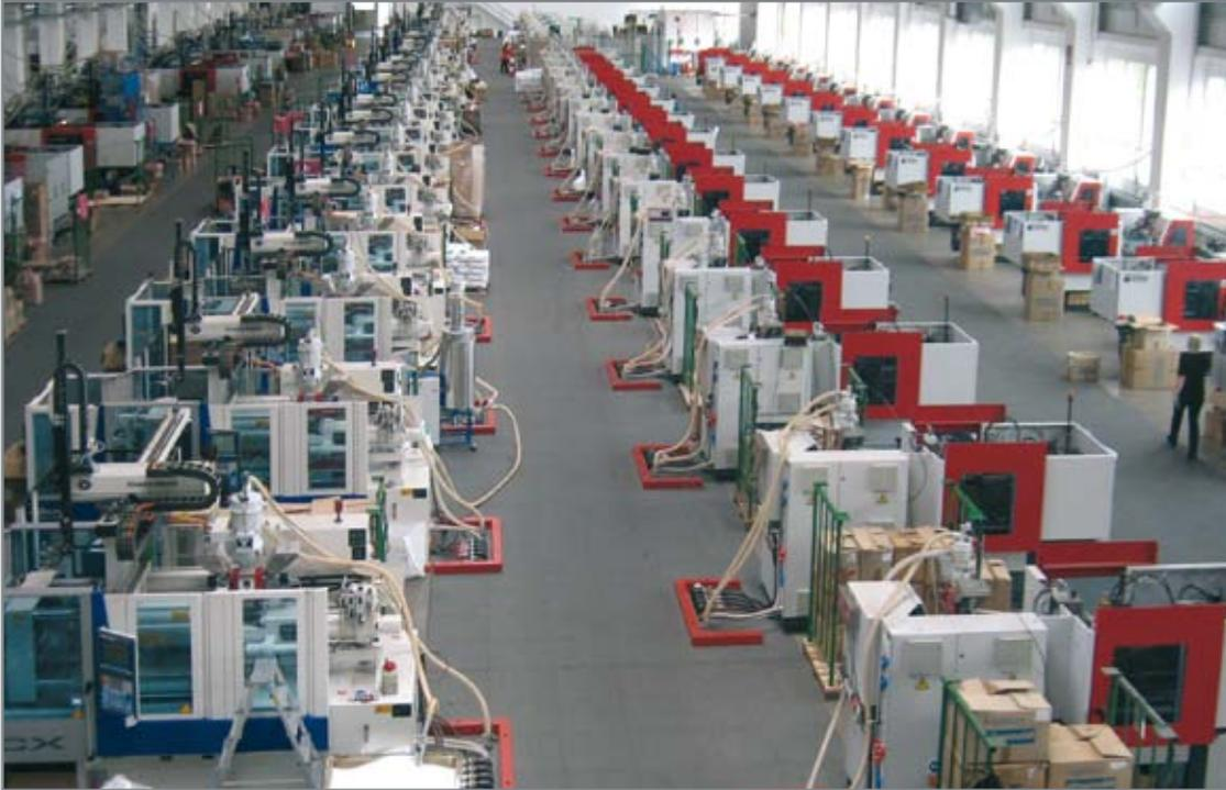
Zentralförderanlage eines großen Spielwarenherstellers mit Förderabscheidern und Trocknungsanlage zur Versorgung von 108 Verarbeitungsmaschinen.
