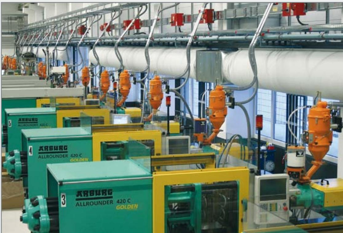
Fördergeräte in Kombination mit Direkteinführung in der Zentralförderanlage eines großen Verpackungsherstellers.
