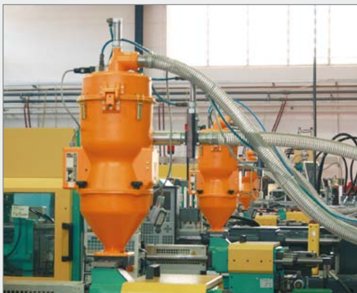
A 8 aufgebaut mit Zwischentrichter Z 5 und Materialverriegelung
