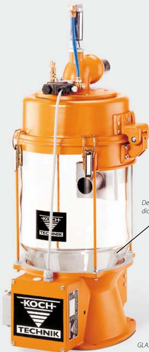
Der Förderbehälter ist komplett aus dickwandigen Spezialglas gefertigt
