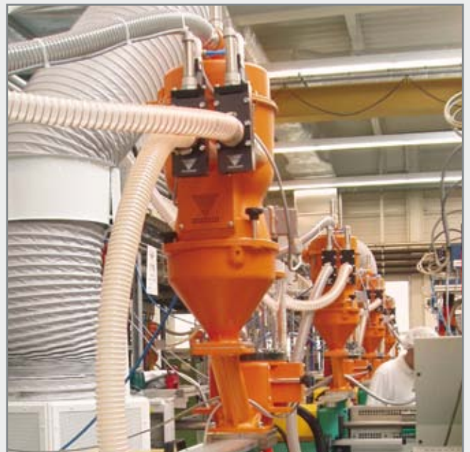
Förderabscheider Tm A 8 zur Verarbeitung von Neuware und Regenerat
