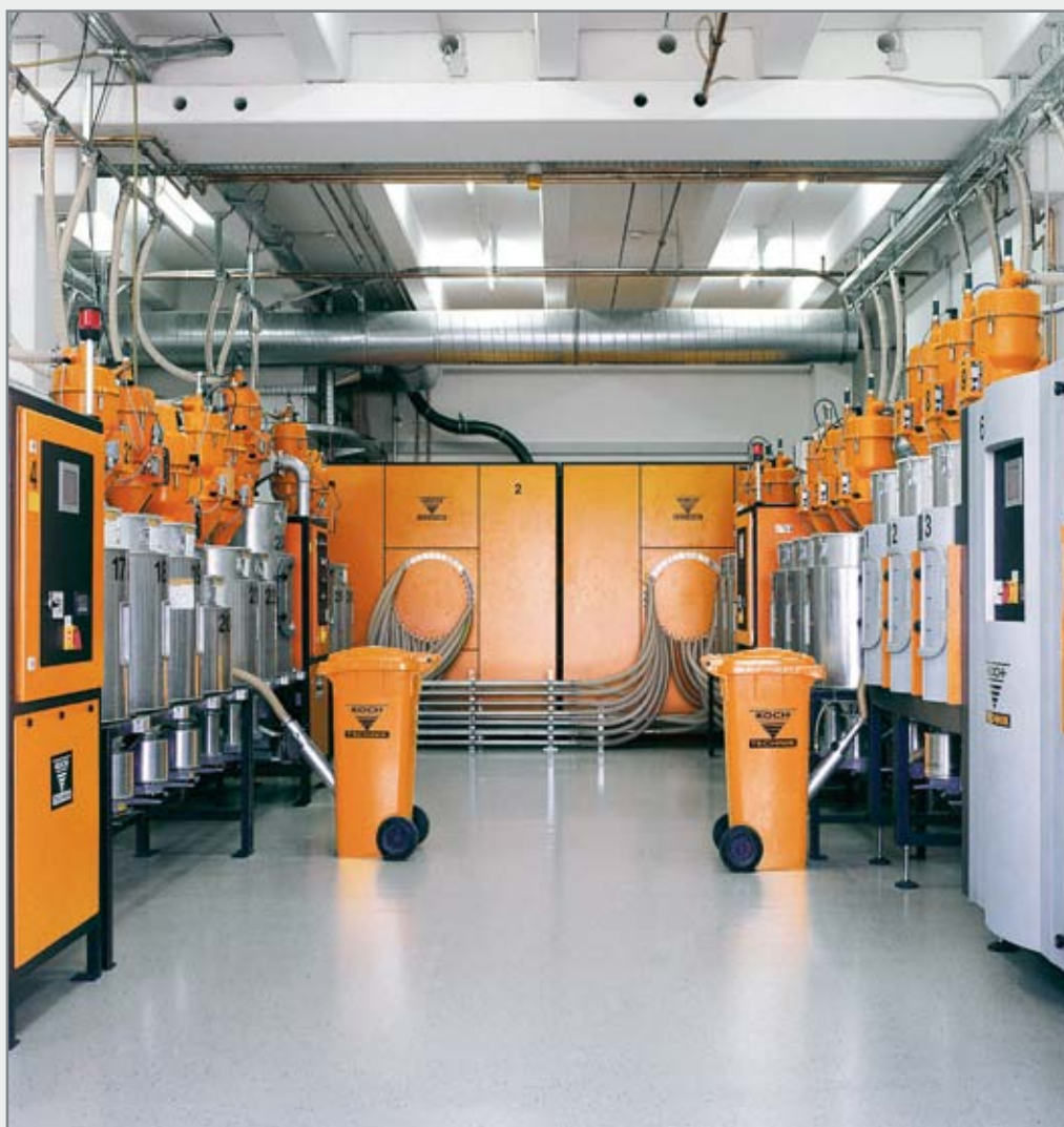
Diese Anlage von insgesamt 6 Granulattrocknern mit 40 Trocknungsbehältern versorgt über zwei Materialverteilssysteme vom Typ NAVIGATOR insgesamt 60 Spritzgießmaschinen mit bis zu 36 verschiedenen Materialien.
