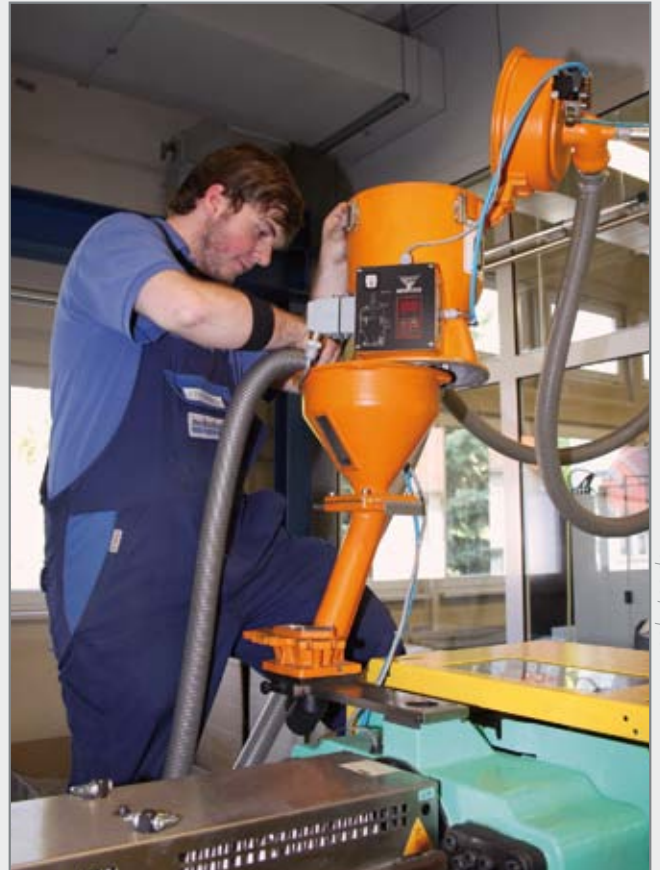
Einfacher Materialwechsel und Reinigung: Direkt auf der Maschine können die Gerätekomponenten geschwenkt bzw. aufgeklappt werden – in kurzer Zeit und völlig ohne Werkzeug. (Bild: K-Zeitung)
