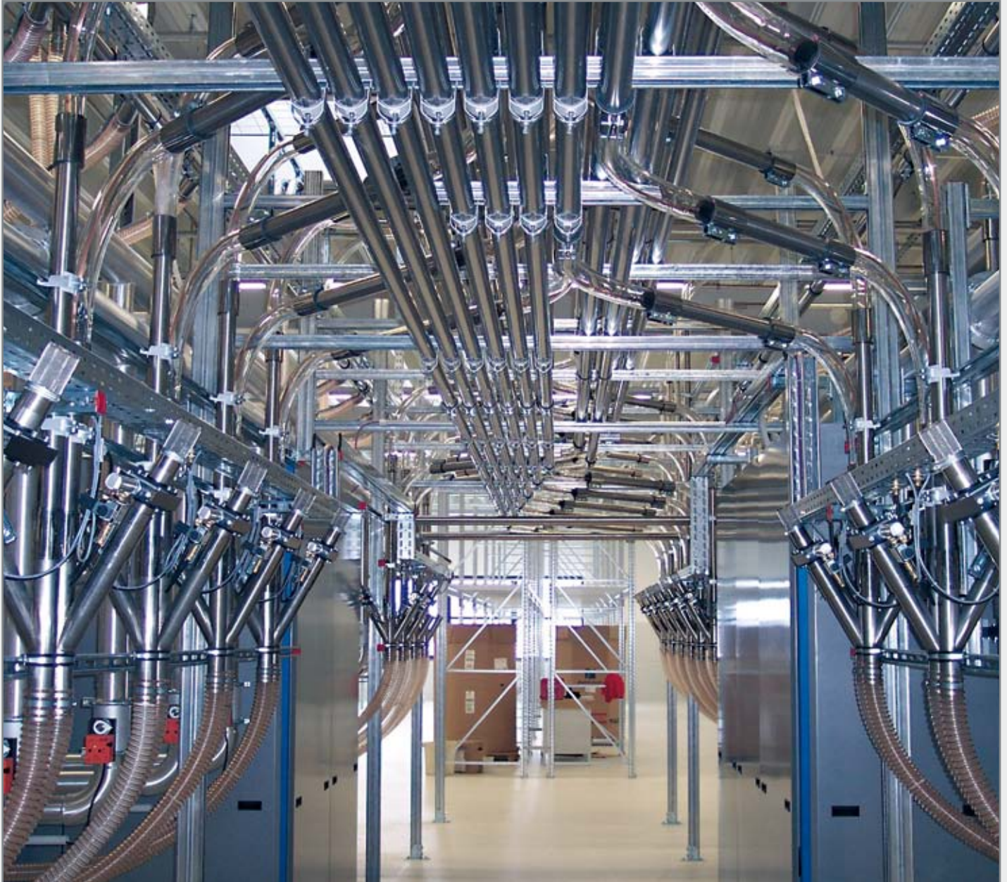
Zentrale Granulatversorgung über 3 CKT Trockner mit insgesamt 30 Trocknungsbehältern werden 60 Verarbeitungsmaschinen zur Herstellung technischer Teile für die Fahrzeugindustrie versorgt. Neben den Rohrleitungen aus V 2 A werden Glasrohrbögen zum Umlenken des harten Materials eingesetzt.
