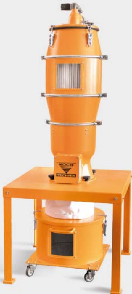
Sa 3 Sicherheitsfilter mit 25l Auffangbehälter
