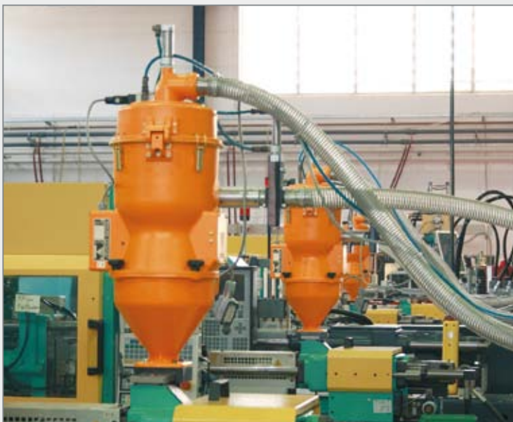
A 8 aufgebaut mit Zwischentrichter Z 5 und Materialverriegelung
