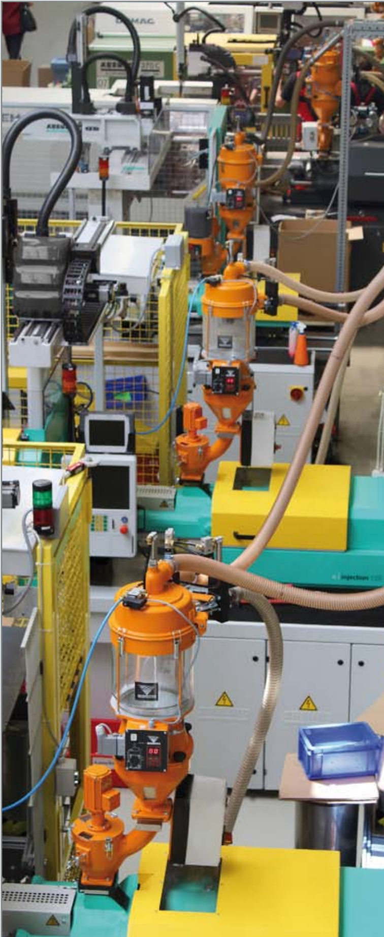
Einfacher Materialwechsel und Reinigung: Direkt auf der Maschine können die Gerätekomponenten geschwenkt bzw. aufgeklappt werden – in kurzer Zeit und völlig ohne Werkzeug. (Bild: K-Zeitung)
