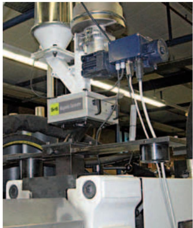
**Der extrem flache Magnet-Separator SAFEMAG wird direkt unterhalb der Dosiereinheit der Spritzgießmaschine installiert.**
