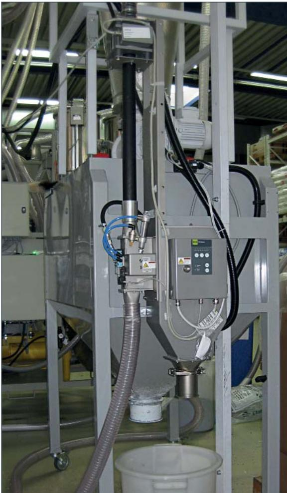
Metall-Separator GF eingebaut in eine vertikale Förderleitung
