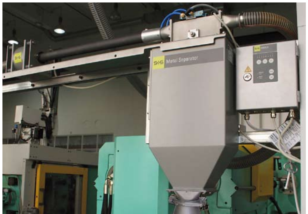
Der Metall-Separator GF PRIMUS von S+S entfernt Metallverunreinigungen aus Kunststoffregenerat und beseitigt dadurch die Ursachen von Maschinenstillständen und fehlerhaften Teilen.
