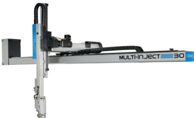
Die Roboter der Multi Inject Baureihe sind die ideale Lösung für die Formteilentnahme an Mehrkomponenten-Spritzgießmaschinen mit vertikaler Spritzeinheit. Bedingt durch die verfahrbare Entformachse können die Roboter die Störkonturen der vertikalen Einspritzeinheit umfahren. Diese Roboter arbeiten ökonomischer als Roboter der Baureihe Speed-Entry und profitieren von der Flexibilität eines linearen 3-Achs-Roboters.
