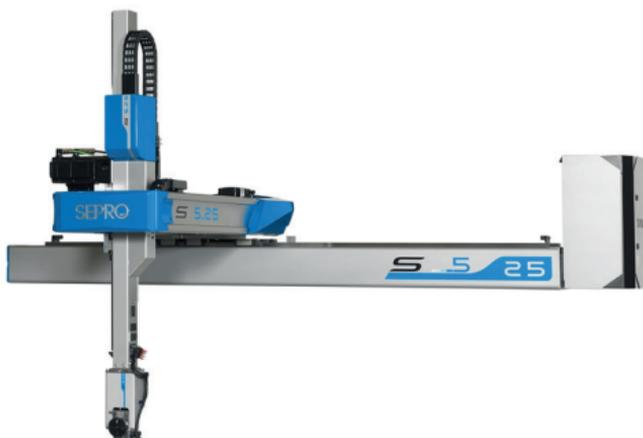
Die 3-Achs-Baureihe S5 Line bietet Ihnen Spitzentechnologie von Sepro: einen Hochleistungsroboter mit cleverem Design. Diese zuverlässigen, schnellen und präzise arbeitenden Roboter sind perfekt für komplexe Anwendungen geeignet.
