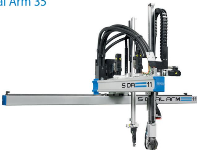
Ein Roboter der Baureihe 5 Dual Arm bietet mit 2-Vertikal-Achsen und insgesamt 5 CNC-Achsen die ideale Lösung für Entnahmeaufgaben aus 3-Platten-Werkzeugen.
