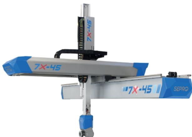
Die Roboter der Baureihe 7X sind die ideale Kombination aus der neuen Generation großer 3-Achs-Roboter von Sepro und einer motorischen Handachse von Stäubli. Die hochwertigen, flexiblen und leistungstarken Roboter der Baureihe 7X eignen sich perfekt zur Handhabung anspruchsvoller Teile oder für Up and Downstream Automationsaufgaben in der Peripherie. Sie stehen für schnellere Produktionswechsel und für eine nachhaltige Investition in zukünftige Produktionsaufgaben.
