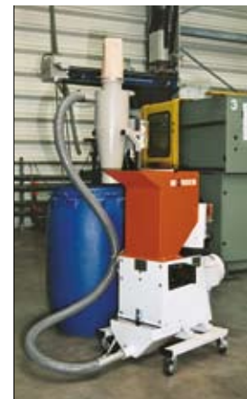
C 13.20 s mit Zyklon. Die Ansteuerung erfolgt durch die Mühlensteuerung, die Förderung erfolgt mittels Preßluft. ▶
