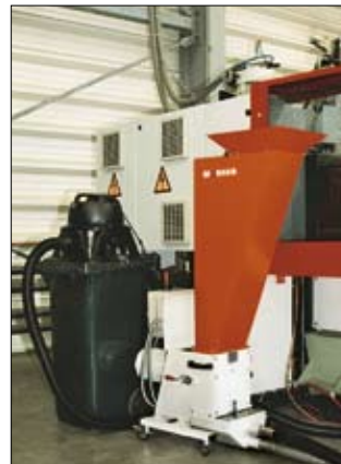
C 13.20 s mit Zyklon. Die Ansteuerung erfolgt durch die Mühlensteuerung, die Förderung erfolgt mittels Preßluft. ▶
